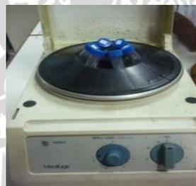
Penghomogenan dengan sentrifuse dengan kecepatan 7500 rpm selama 5 menit
