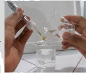
Pembilasan elektroda pH meter menggunakan akuades
