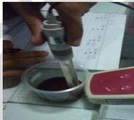
Pencelupan elektroda pada sampel
