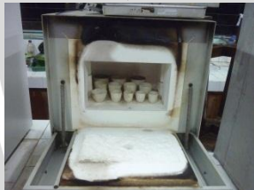
Pengabuan dalam muffle pada suhu 600°C
