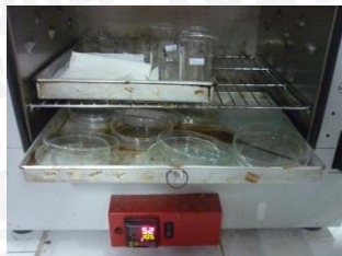
Pengeringan cawan petri dalam oven pada suhu 105°C selama 24 jam dengan tutup setengah terbuka
