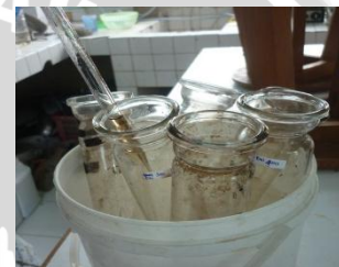
Penuangan sampel, tablet kjeldahl dan 15 mL H 2 SO 4 kedalam labu destruksi
