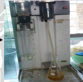
Pendestilasi selama 3 menit dan destilasi ditampung dalam Erlenmeyer
