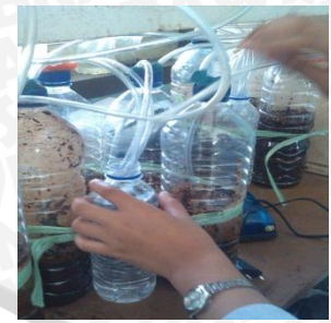
Pemasangan aerasi dan di fermentasi selama 3,6,9, dan 12 hari pada suhu ruang
