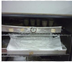
Pengeringan kertas saring dan benang kasur pada suhu 105°C selama 24 jam
