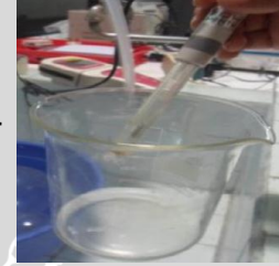
Pembilasan elektroda pH meter menggunakan aquadest
