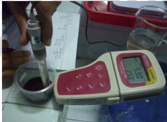
Pencelupan elektroda pada sampel dan ditunggu beberapa detik sampai nilai pH stabil
