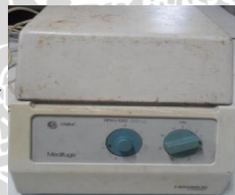
Penghomogenan dengan sentrifuge dengan kecepatan 7500 rpm selama 5 menit
