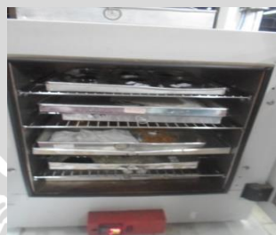
Pengeringan dalam oven dengan suhu 105°C selama 4 jam dengan tutup setengah terbuka
