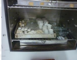
Pengeringan cawan porseline pada suhu 105°C selama 24 jam
