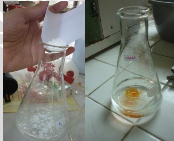
Penambahan 1,5g H 3 BO 3 dan akuades 50 mL, dan metyl orange kedalam erlenmeyer
