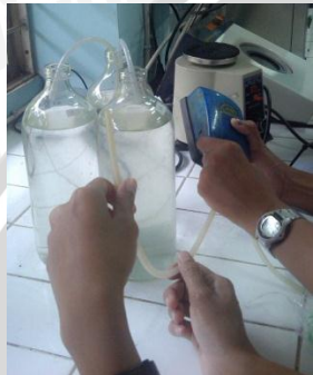
Pemasangan selang aerasi
