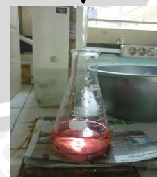
Pentitrasi dengan H 2 SO 4 0,3 N sampai berubah warna merah muda
