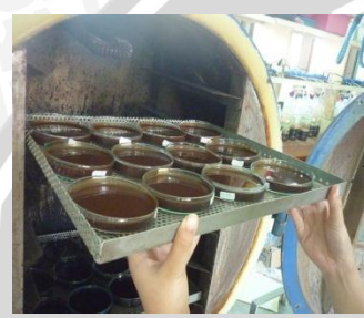
pengeringan dalam oven vakum dengan suhu 55°C selama 12 jam
