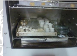
pengeringan sampel pada suhu 105°C selama 24 jam
