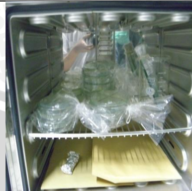
14. Inkubasi pada suhu 37° C selama 24 jam
