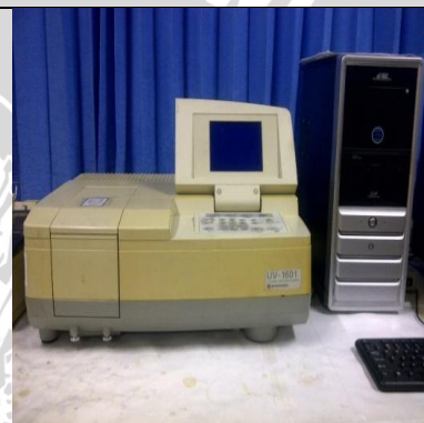
16. Analisa spektrofotometri Uv-Vis SHIMADZU
