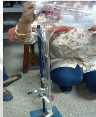
Proses memasukkan bubur silica gel ke kromatografi kolom
