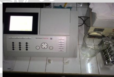
Pengukuran absorbansi 760nm menggunakan spektrofotometri UV-Vis
