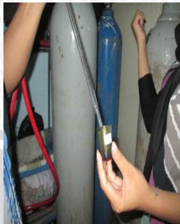
proses penguapan sisa pelarut dengan nitrogen
