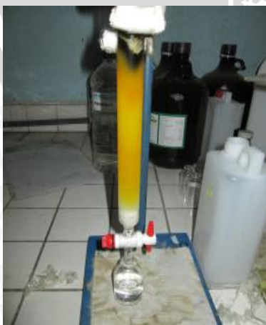
Isolasi \beta karoten dengan kolom kromatografi
