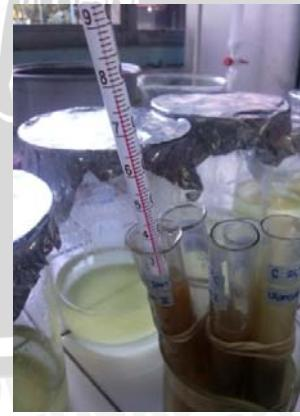
f) Pengukuran suhu *melting point* menggunakan termometer
