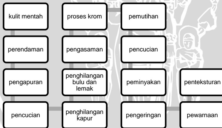
Gambar 2. Skema Proses Penyamakan Kulit
