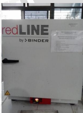
Pengovenan suhu 105^{\circ}\text{C} selama 3 jam
