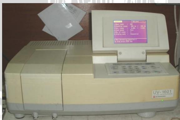
Gambar 5 . Spektrofotometer UV-Vis
