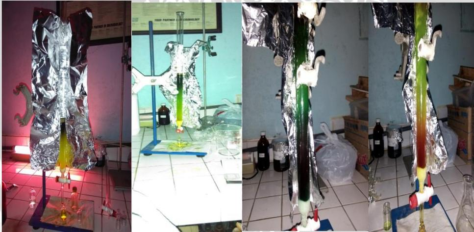
**Gambar 17.** Hasil Isolasi Kolom Kromatografi
