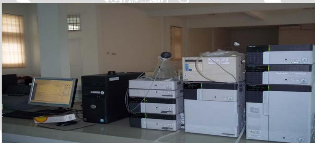
a. Rangkaian Alat Instrumen Kromatografi Cair Kinerja Tinggi (KCKT)
