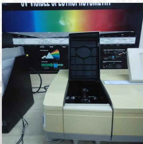
d. Cuvet dimasukkan dalam alat spektrofotometer
