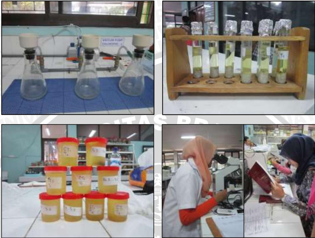
Gambar 25. Pengukuran Klorofil-a dengan Vacuum Pump dan Pengamatan Serta Identifikasi Fitoplankton
