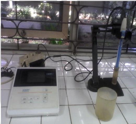
Alat Untuk Mengukur Eh dan Ph sedimen
