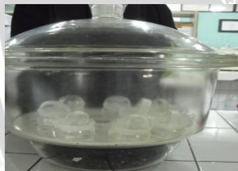
Dimasukkan dalam desikator selama 30 menit
