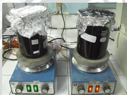
Diaduk dengan magnetic stirrer selama 12 jam
