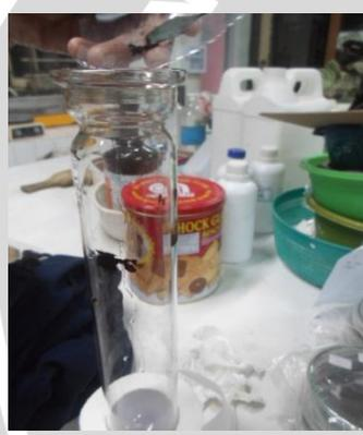
Penuangan sampel dan table kjeldahl ke dalam labu destruksi
