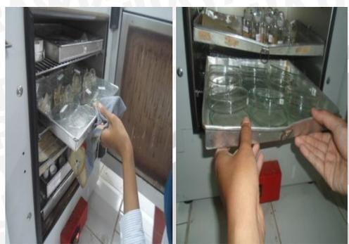
Pengeringan cawan petri dalam oven pada suhu 105°C selama 24 dengan tutup setengah terbuka
