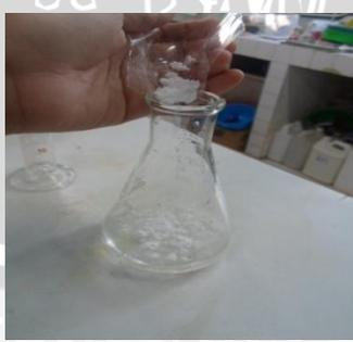
Penuangan sample H<sub>3</sub>BO<sub>3</sub> ke dalam Erlenmeyer yang berisi aquades 50 ml
