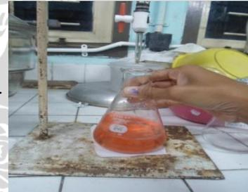
Penitrasi destilasi dengan  $H_2SO_4$  0,3 N hingga berubah warna merah muda
