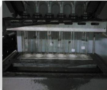
Destruksi pada suhu  $370^{\circ}C$  selama 3 jam
