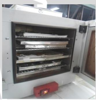
Pengeringan dalam oven pada suhu 105°C selamam 3 jam dengan tutup setengah terbuka
