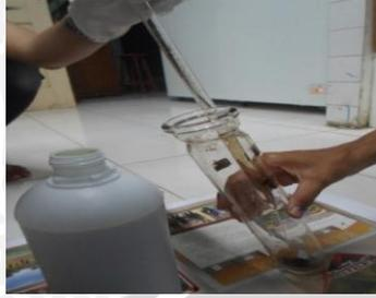
Penuangan larutan  $H_2SO_4$  Teknis sebanyak 15 ml ke dalam labu destruksi
