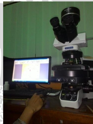
Mikroskop Olympus BX53 untuk analisa mikronuklei (Mn)
