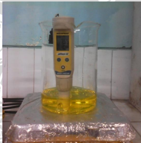
Pengukuran pH dan suhu larutan logam berat Cr(VI)
