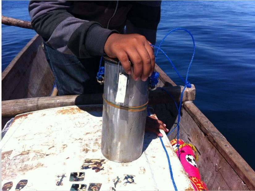
**Gambar 25.** Pengambilan sampel air laut menggunakan *water sampler*
