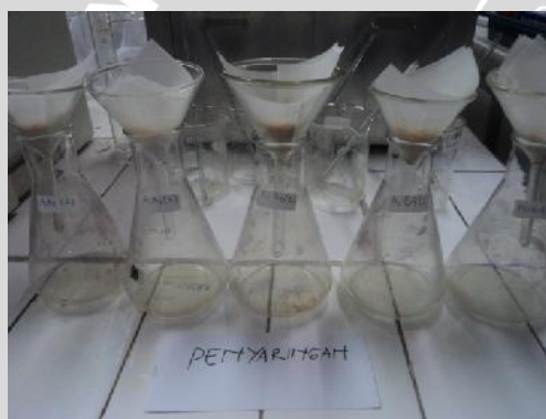
Ekstraksi garam menggunakan aquades panas
