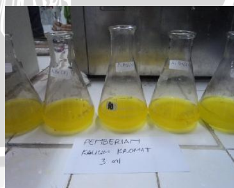
Cairan ekstrak garam setelah ditetesi 3 ml kalium khromat 5%
