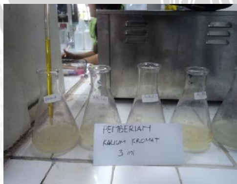
Pemberian 3 ml kalium khromat 5% ke cairan ekstrak garam
