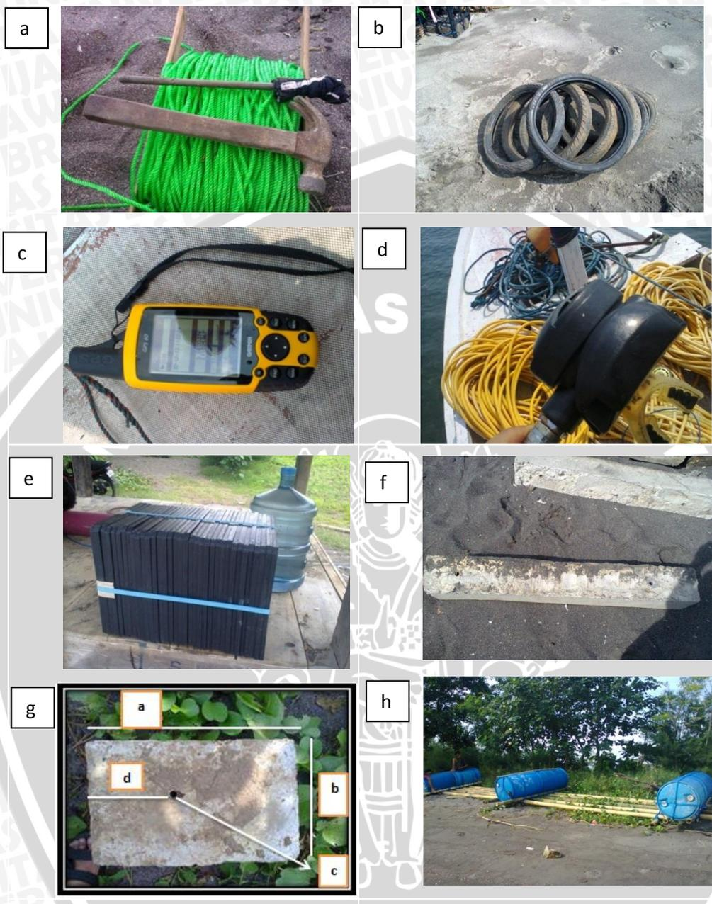
Keterangan gambar 6: gambar (a). Tali tampar berdiameter 4 mm; (b). Ban motor bekas berdiameter 44 cm; (c). GPS 60 Map Garmin; (d). Komponen kompresor; (e). Satu paket partisi (50 buah/Tebal tiap-tiap Partisi 1,3 cm); (f). Pemberat persegi panjang; (g). Pemberat tengah (ukuran: a= 40 cm, b= 25,5 cm, c= 16 cm dan d= 1,6 cm); (h). Rakit pengangkut apartemen ikan.
