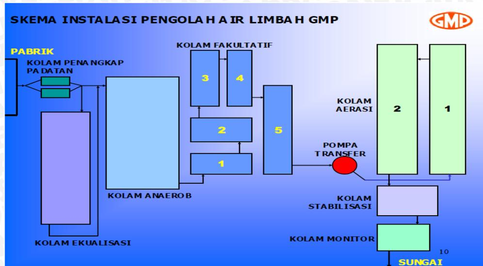
Gambar 1. Contoh Skema Instalasi Pengolahan Air Limbah Pada Pabrik Gula (Tugiyono *et al.*, 2009).
