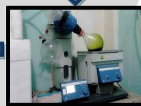
Dilakukan pemisahan pelarut dengan Vaccum Rotary Evaporator
