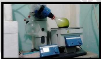
Dilakukan pemisahan pelarut dengan *Vaccum Rotary Evaporator*
