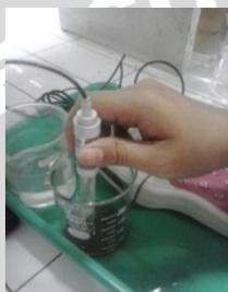
pencelupan elektroda pada sampel (sampai pembacaan stabil)
