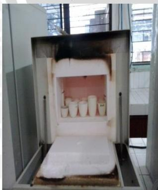
Pengabuan di dalam muffle dengan suhu 600°C selama 3 jam
