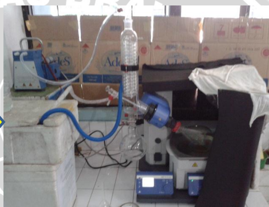
Pemisahan pelarut dengan sampel menggunakan vacuum rotary evaporator
