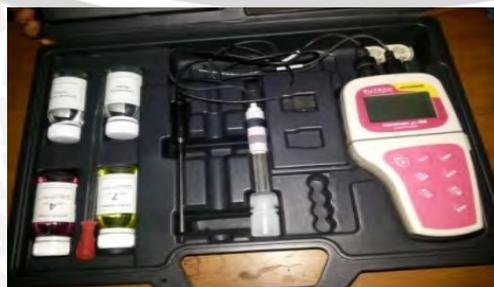
**Gambar 20.** Pengukuran pH sampel air lumpur dan sedimen padat Lapindo
