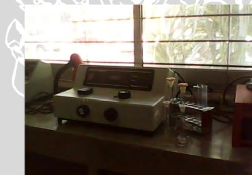
**Gambar 23.** Pengukuran Kadar Logam Berat dengan Spektrofotometer
