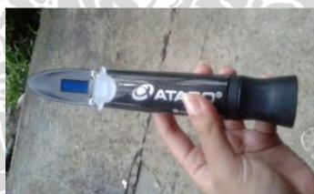
**Gambar 21.** Pengukuran Salinitas dengan Refraktometer
