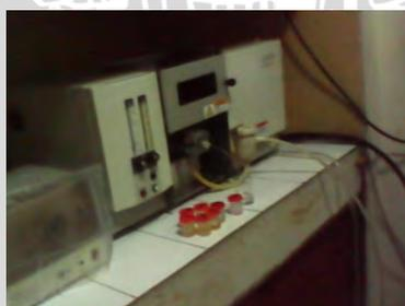
**Gambar 22.** Pengukuran Kadar Logam Berat dengan AAS
