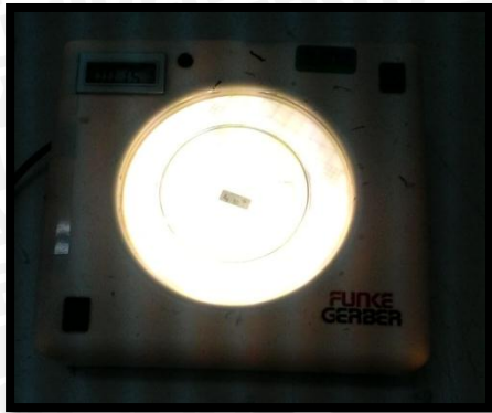
13. Penghitungan koloni dengan colony counter.
