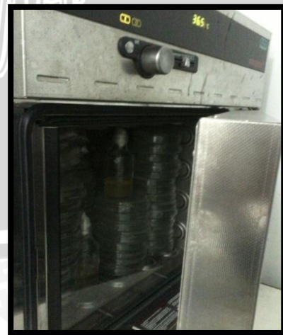
12. Inkubasi suhu 37°C selama 48 jam.
