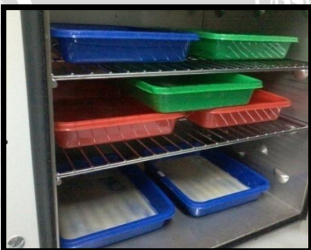
5. Pemanasan pada oven suhu 55°C.
