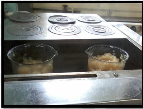
7. Pemanasan di waterbath suhu 80°C.
