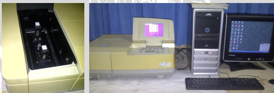
Proses Uji Spektrofotometer UV-Vis isolat \beta -Karoten E. cottonii & E. spinosum
