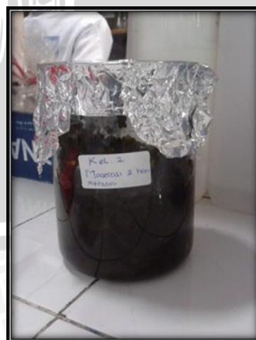
Dimaserasi dengan metanol selama 2x24 jam dan dibungkus aluminium foil
