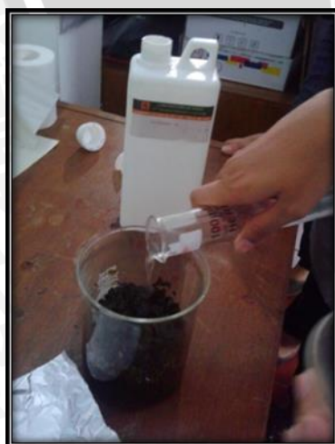
Dimaserasi dengan metanol selama 2x24 jam dan dibungkus aluminium foil
