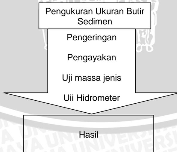
Gambar 3. Tahap Pengukuran Sedimen
