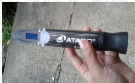
Gambar 13. *Handrefraktometer*
