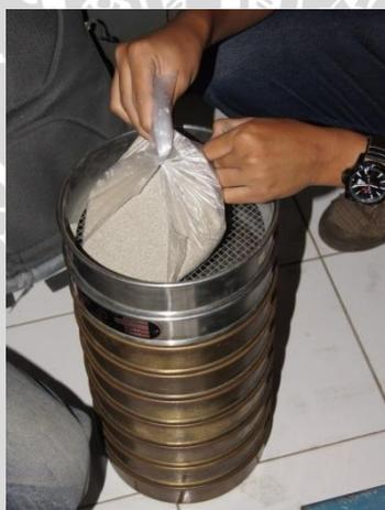
Penuangan Sampel ke dalam Sieve Shaker
