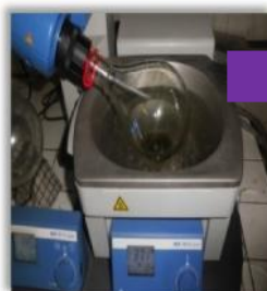
Dilakukan Pemisahan Pelarut dengan Vaccum Rotary Evaporator
