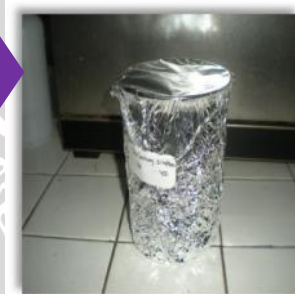
Serbuk Daun Sembung Dimasukkan dalam Wadah, Dicampurkan Etanol dan Wadah Ditutup dengan Alumunium Foil (Didiamkan 48 jam)
