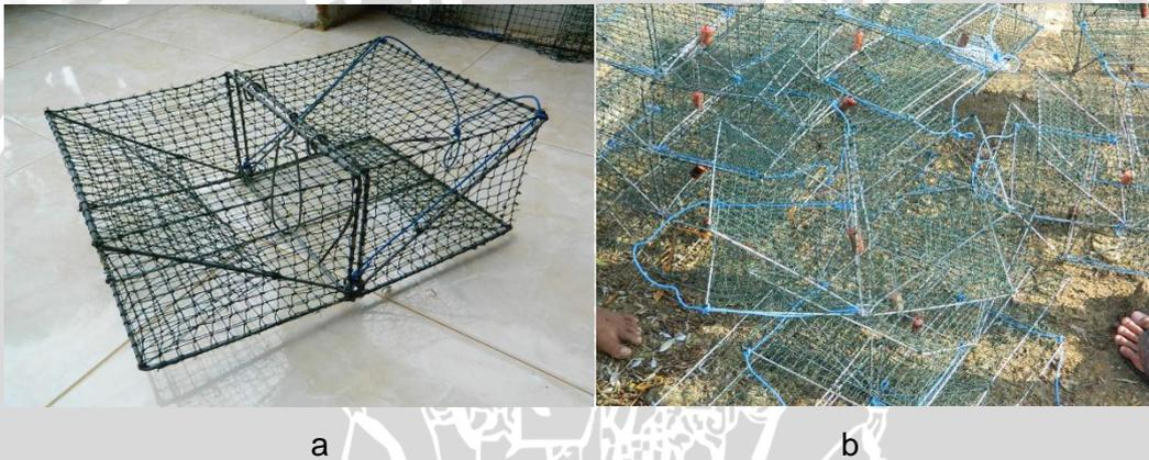
Gambar 8. Bentuk Alat Tangkap Kepiting Bakau (a) dan Bubu dengan Umpan Belut (b)
