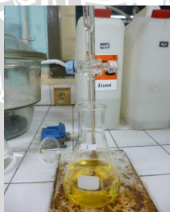
Titrasi pada destilat dengan H_3BO_3 dan mencatat hasil titrasinya
