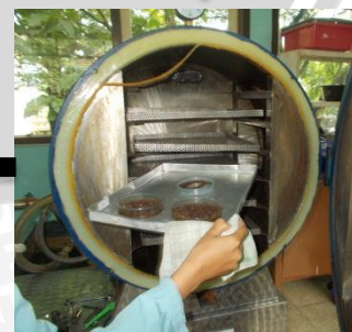
Pengovenan menggunakan oven vacum suhu 55°C selama ± 15 jam
