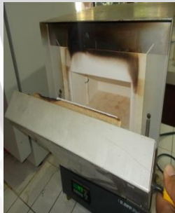
Memasukkan kedalam tanur pengabuan suhu 600°C selama 3 jam
