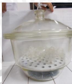
Memasukkan kertas saring dan tali kedalam desikator 15 menit
