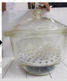
Memasukkan cawan kedalam desikator 15 menit
