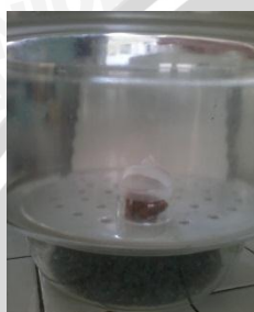
Memasukkan cawan kedalam desikator 15 menit
