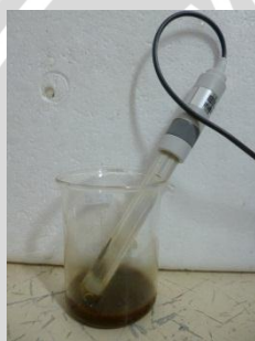
Pencelupan elektroda pada sampel (sampai pembacaan stabil)
