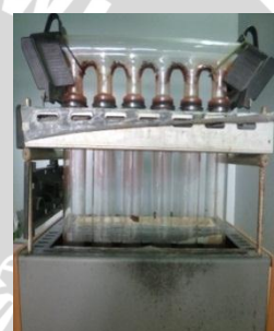
Memasukkan sampel, tablet kjedhal dan H_2SO_4 kedalam alat destruksi dan pendestruksian selama 3 jam
