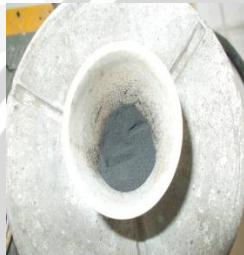
Melakukan pengarangan hingga membara dan tidak berasap
