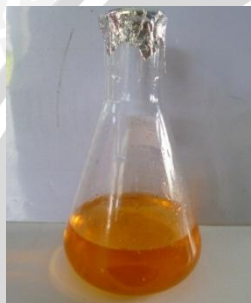
Penambahan H_3BO_3 dengan indikator metile orange
