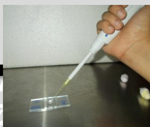
Meneteskan sampel ke kaca hemosito dan ditutup cover glass
