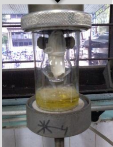
Memasukkan sampel kedalam goldfish selama 3 jam
