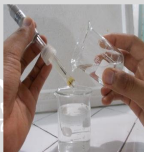
Membilas elektroda dengan akuades
