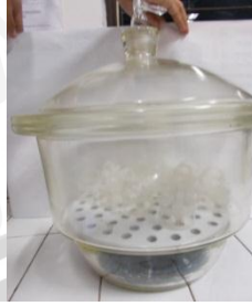
Memasukkan cawan kedalam desikator 15 menit
