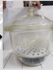
Memasukkan sampel kedalam desikator 15 menit
