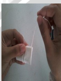
Membungkus sampel dengan kertas saring dan mengikatnya dengan tali
