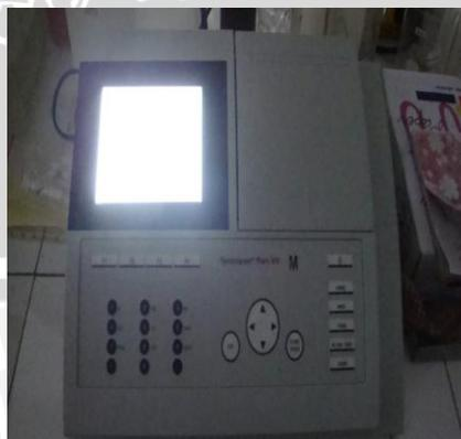
30. Proses perhitungan absorbansi sampel menggunakan spektrofotometer UV-Vis
