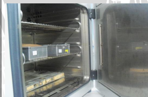
Proses pengovenan adonan pada suhu 106°C
