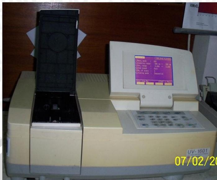
**Gambar 6. Spektrofotometer UV-1601
