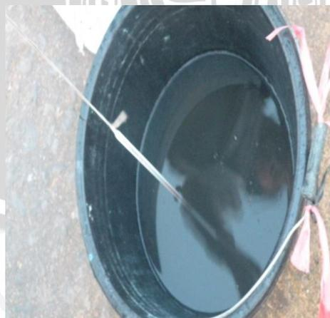
Gambar 9. Pengukuran suhu sampel di sungai boni
