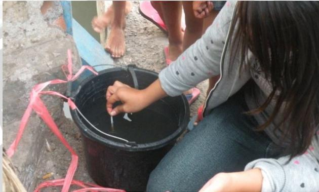
Gambar 10. Pengukuran pH pada sampel di sungai boni
