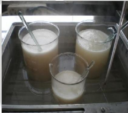
Gambar c. Proses ekstraksi dengan KOH pada suhu  $\pm 80^{\circ}\text{C}$  selama 2 jam
