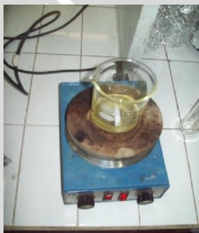
Gambar c. Pemanasan minyak pada suhu  $\pm 40^{\circ}\text{C}$
