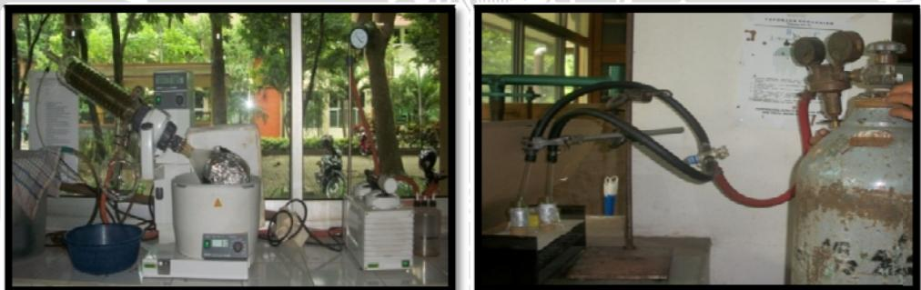
**Gambar 3. Proses Evaporasi dan Pengeringan Sampel dengan Gas N<sub>2</sub>**
