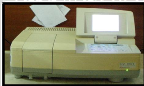
**Gambar 6. Spektrofotometer UV-1601**
