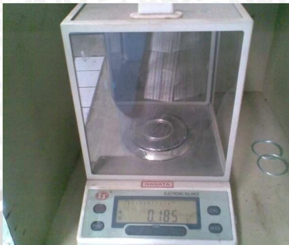
Gambar 7. Pengujian Denier Menggunakan Neraca Elektronik
