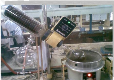
Gambar 7. Proses pengentalan dengan rotari
