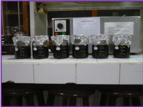
6. Sampel dimaserasi dalam inkubator oven (ruang gelap) suhu 40°C
