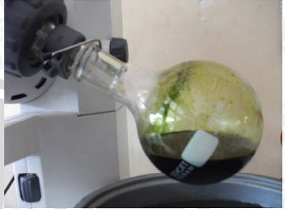
8. Pemisahan pelarut dengan *vacuum rotary evaporator*
