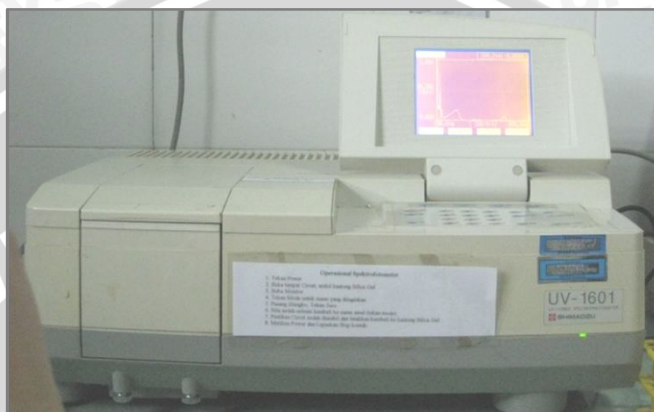
Gambar 7. Multispec-1601 Spektrofotometer Sumber : Laboratorium Kimia Organik Fakultas MIPA, Universitas Brawijaya
