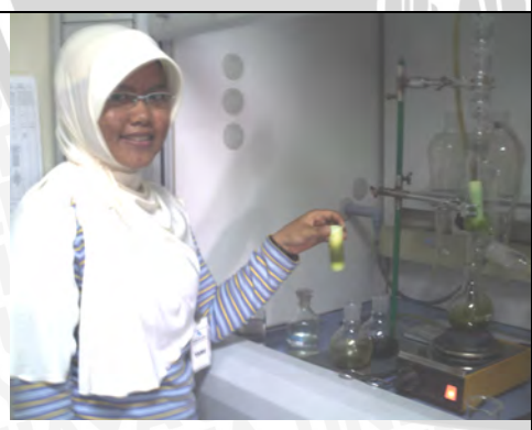
Proses Ekstraksi dengan Metode Sokletasi
