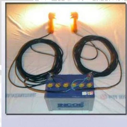
1. Lampu Halogen adalah sejenis lampu pijar. Lampu ini memiliki kawat pijar tungsten seperti lampu pijar biasa yang digunakan di rumah, tetapi bola lampunya diisi dengan gas halogen. Pada prinsipnya kerja lampu halogen karena atom tungsten, oksigen dan halogen bergabung pada dinding bola lampu membentuk molekul oksihalida tungsten. Kelebihan lampu halogen dari lampu biasa adalah umur lebih panjang, lebih kompak, lebih banyak cahaya dan cahaya lebih putih.
