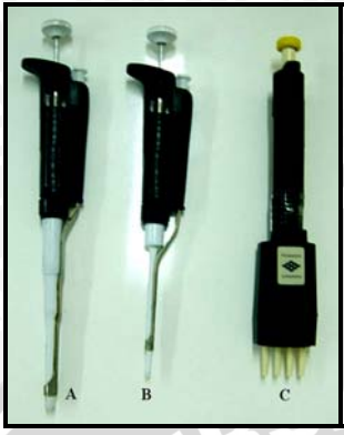
A. Pipet Mikro 1000 µl B. Pipet Mikro 200 µl C. Pipet Mikro 50 µl
