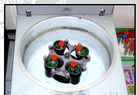
Sentrifugasi 1000 rpm selama 5'. Pencucian dengan PBS dilakukan sebanyak 3 kali.
