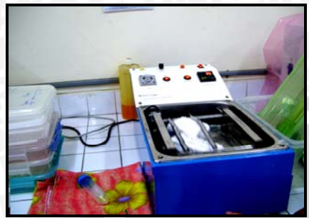
Digoyang pada shaker waterbath dengan suhu 37 °C selama 15'.
