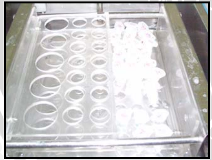
Digoyang lagi pada shaker waterbath suhu 37 ^{\circ} C, selama 30 menit
