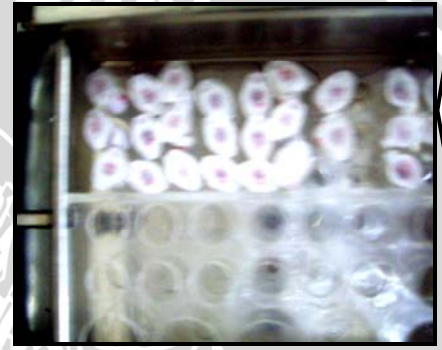
Digoyang pada shaker waterbath suhu 37 ^{\circ} C, selama 30 menit
