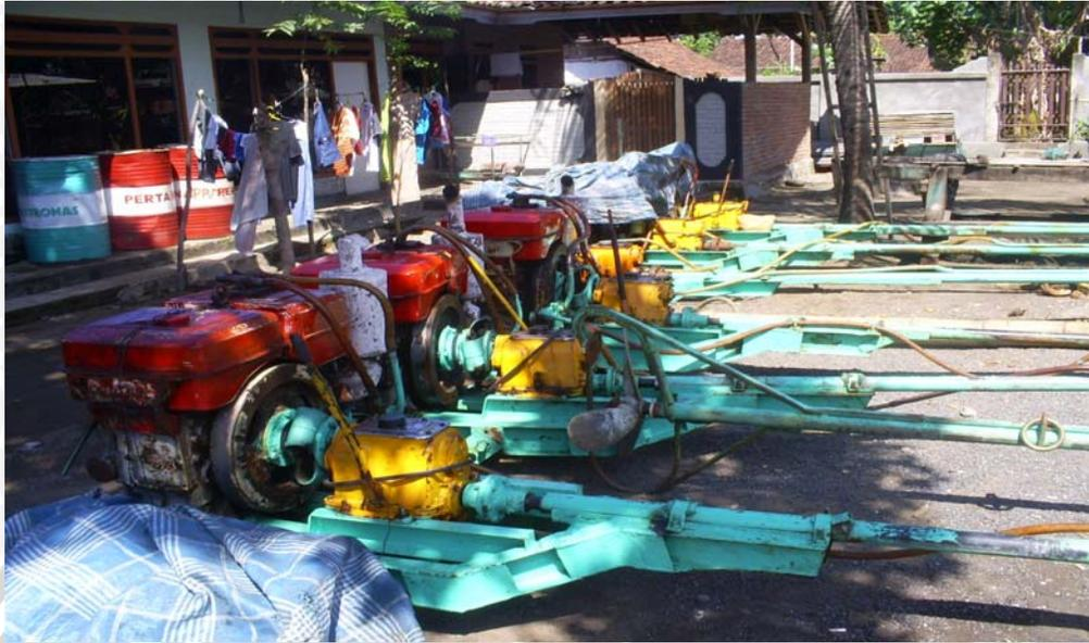
Gambar 5. Mesin dilengkapi dengan Gear Box
