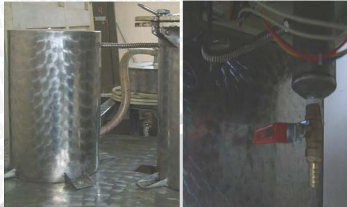
Gambar 8. Kondensor (kiri) dan kran kondensat (kanan)
